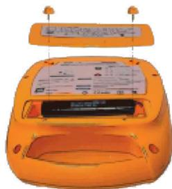
Asegúrese de que el pack de batería no haya expirado. No deben usarse baterías vencidas. Cuando el pack de batería esté instalado, el DEA se encenderá y ejecutará una prueba sobre este. Espere que la prueba se complete y que la unidad se apague. Para más información, refiérase a la página 17 de esta guía.
