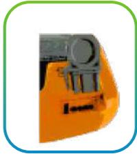
Inserte el extremo del conector del cable de los electrodos de desfibrilación en la toma del conector situado en la esquina superior izquierda del DEA, tal como se muestra. Inserte el conector de los parches firmemente hasta que esté completamente asentado en la unidad. El conector solo encaja en un sentido; si no encaja, gírelo antes de volver a intentarlo.
