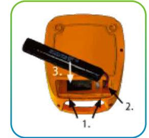
1. Desenrosque y retire los tornillos de mariposa para abrir el compartimento de la batería.
